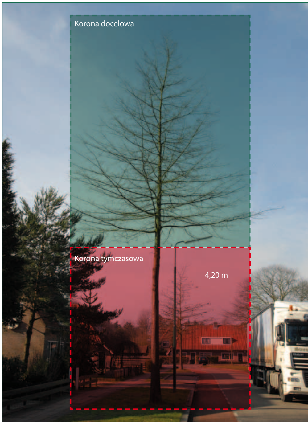
II. 32: W tej sytuacji, w Holandii wysokość skrajni dla ruchu powinna wynosić minimum 4,20 m. Rzeczywista wysokość pozbawionego gałęzi pnia wynosi 5,00 m. Chodzi o to, by również w przyszłości, gdy gałęzie obwisną, została zachowana skrajnia o wysokości 4,20 m
